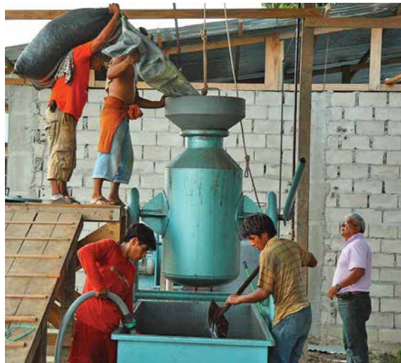
Planta procesadora de ASCART donde hierven y secan las castañas antes de pelarlas
